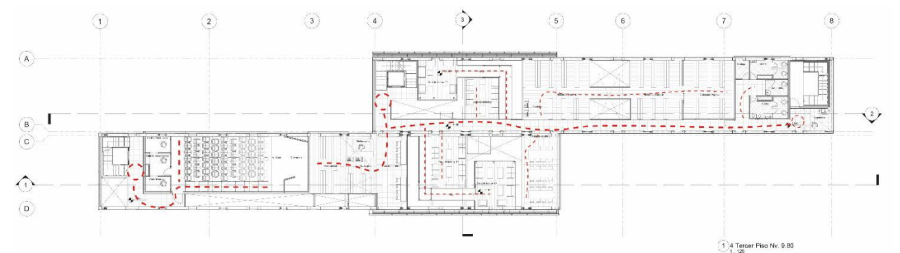
Figura 197. Circulación Tercer Piso
