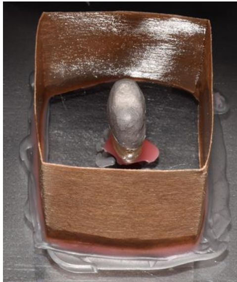
Figura 26. Corona en dado para colar con Pólimetil Metacrilato
