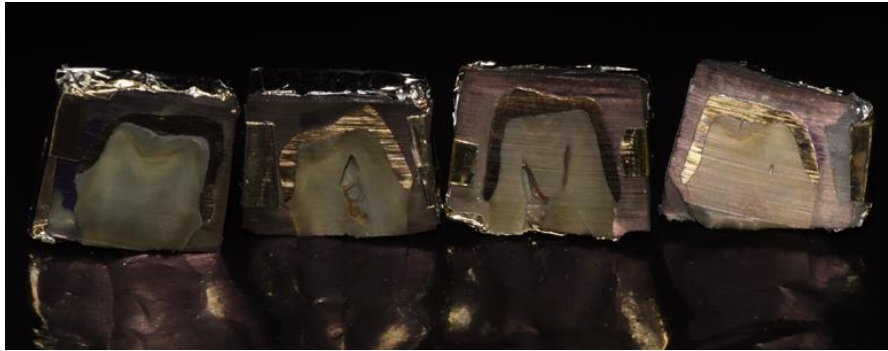
Figura 30. Muestras después de aplicado el oro Sputter a 20 nm
