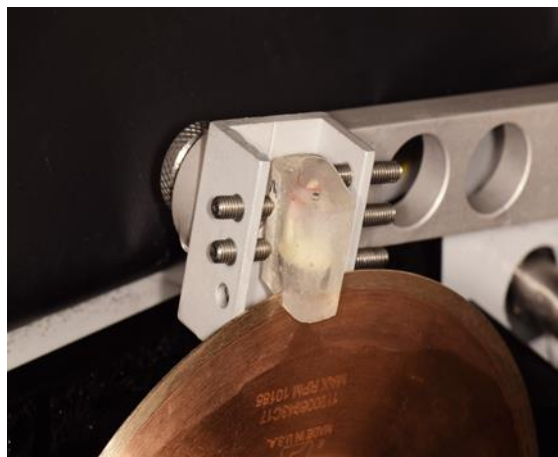
Figura 27. Muestra siendo cortada a 950 RMP
