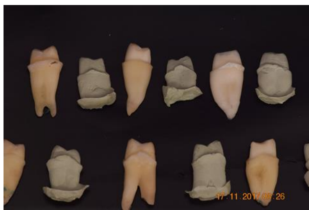
Figura 13. Muestras vaciadas en yeso tipo IV
