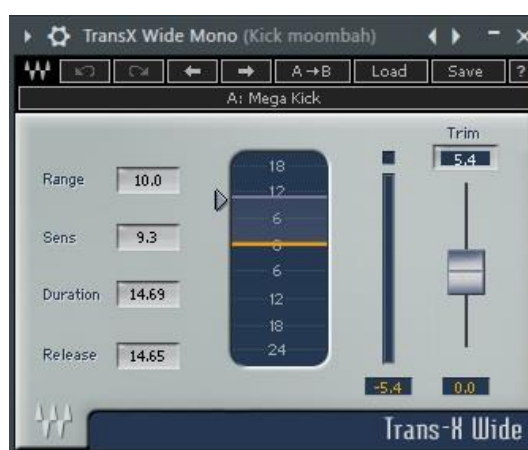
Figura 128. Modelador de transiente usado en el kick . Capturado de la sesión original del tema Girl on fire .
