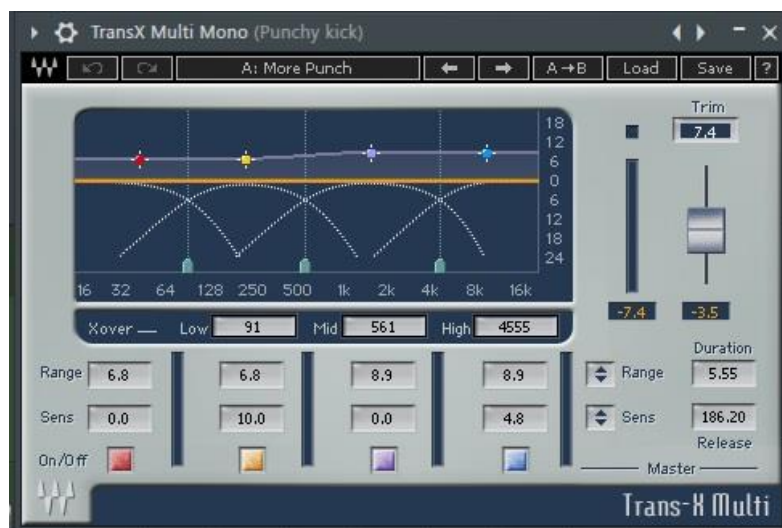
Figura 46. Modelador de transiente usado en el kick . Capturado de la sesión original de Andes .
