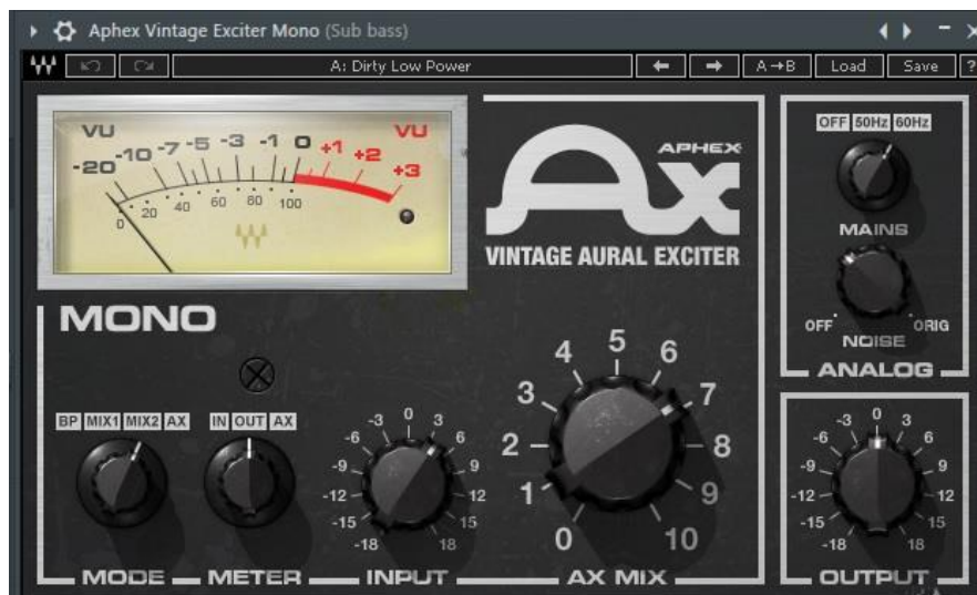
Figura 92. Excitador de armónicos usado en el sub bass . Capturado de la sesión original de Below .
