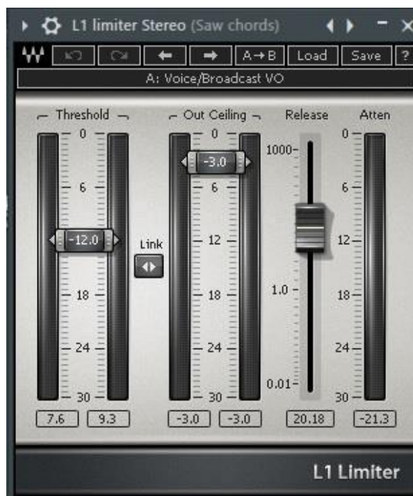
Figura 100. Limitador usado en el sintetizador. Capturado de la sesión original de Below .
