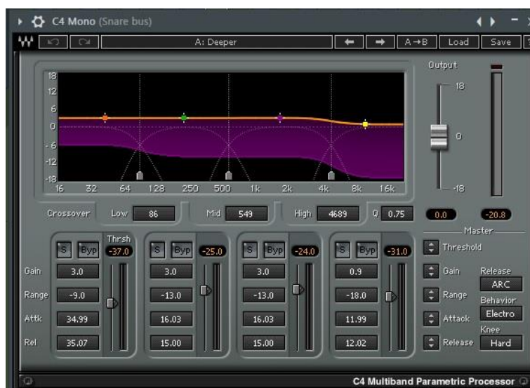
Figura 131. Compresor multibanda usado en el snare . Capturado de la sesión original del tema Girl on fire .
