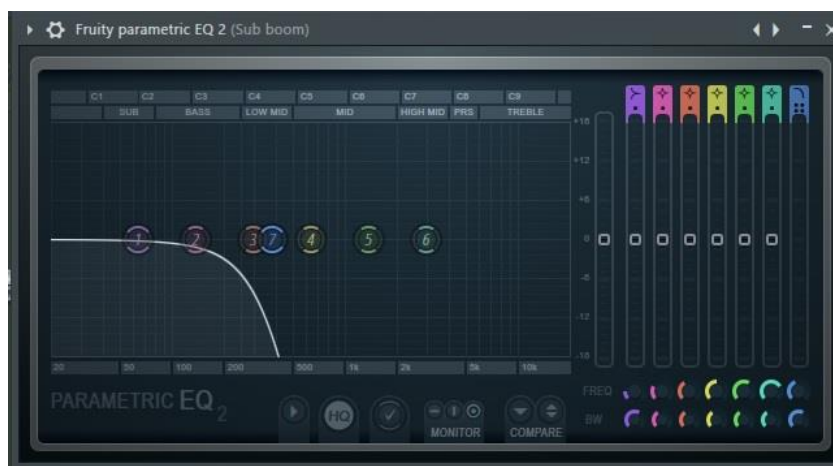
Figura 153. Filtro usado en el sub boom . Capturado de la sesión original del tema Girl on fire .
