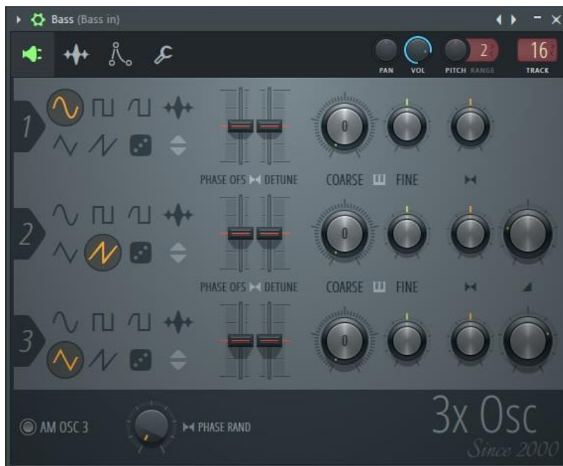
Figura 73. Sintetizador 3x Osc programado para emitir un sonido lleno de armónicos. Capturado de la sesión original de Below .
