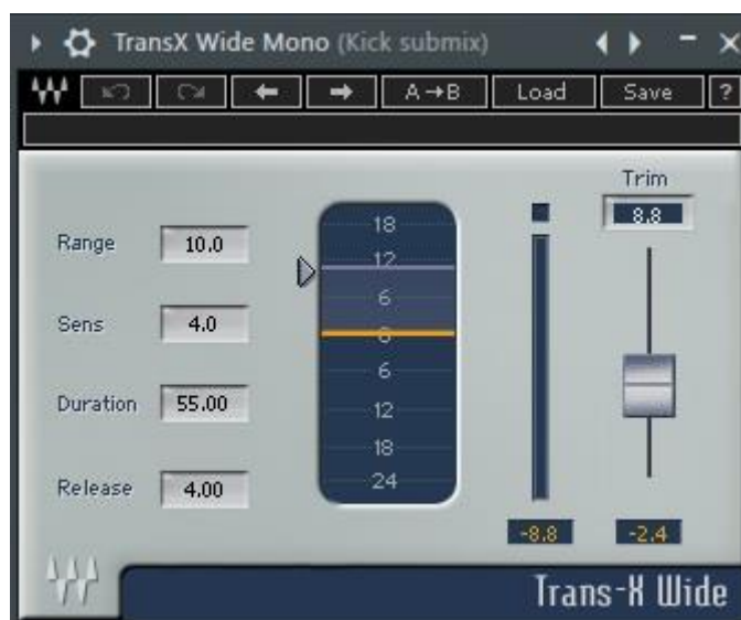
Figura 85. Modelador de transiente usado en el kick . Capturado de la sesión original de Below .
