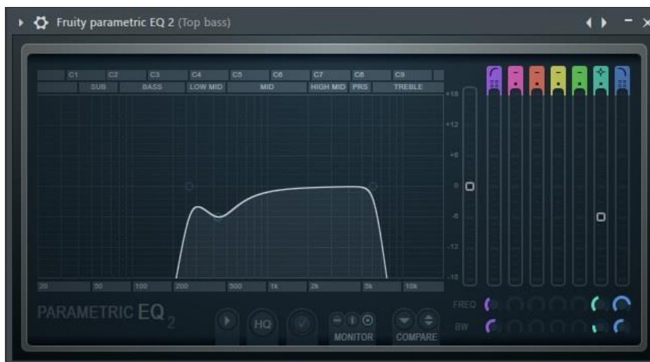
Figura 95. EQ usado en el top bass . Capturado de la sesión original de Below .
