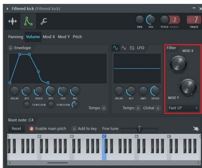
Figura 10. Sampler nativo de FL Studio 12 cargado con el sample del kick usado en el track . Sección de filtros resaltada indicando el uso de un low pass . Capturado de la sesión original del tema Andes .
