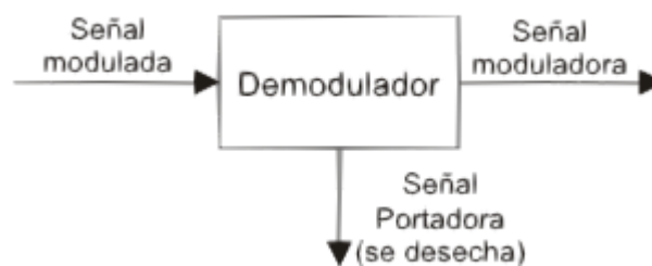
Figura 6. Ilustración de funcionamiento Demodulador. Adaptado de Lorenzo Cruz (2012)
