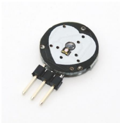
Figura 4. Sensor cardíaco compatible con Arduino Mega. Tomado de Td robótica online
