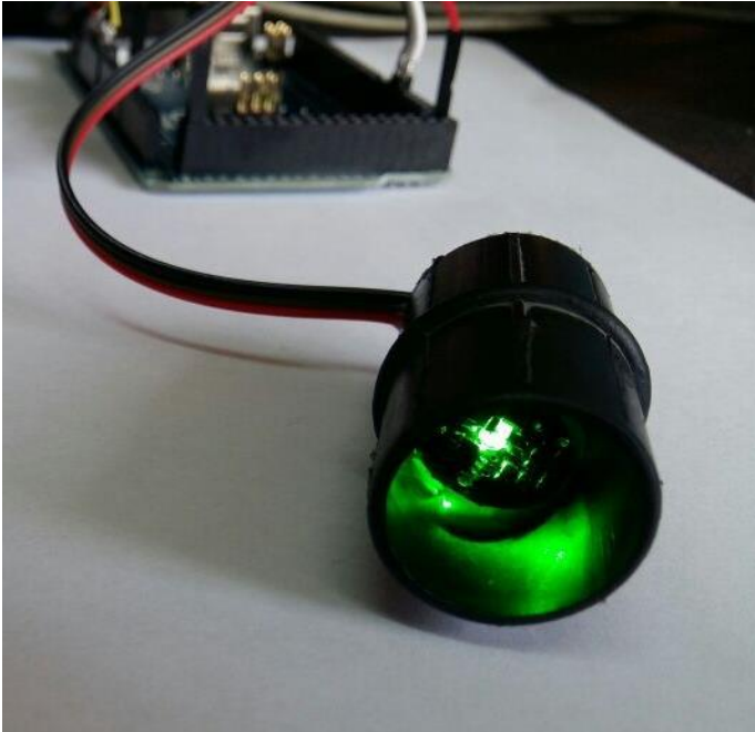
Figura 9. Sensor de pulso adaptado al dedo humano
