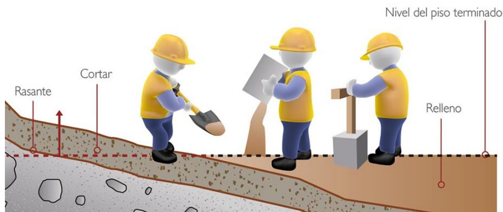
Figura 24 Nivelación del terreno
