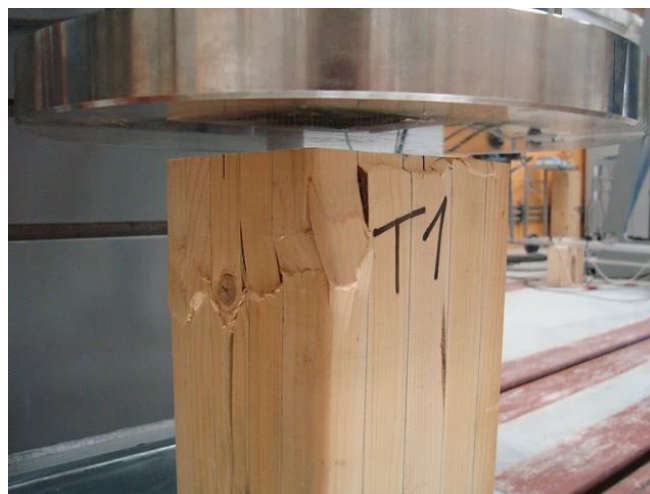
Figura 10 Compresión paralela madera Recuperada de www.pemade.com/ensayos-para-madera-estructural?lightbox=dataItem-ikh63jo9
