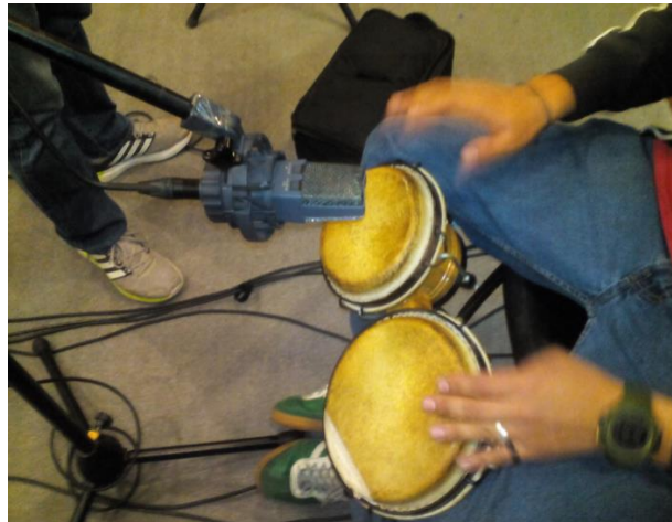
Figura No. 10: Técnica de microfónica para bongos con AKG C414
