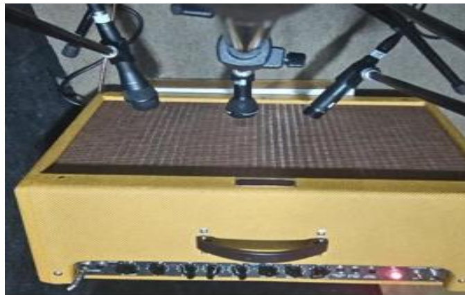
Figura No. 12: Microfonía para amplificador tubular Fender Blues Deluxe
