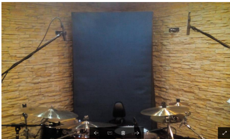
Figura No. 7: Técnica de microfonía para Overheads con Neumann KM184.
