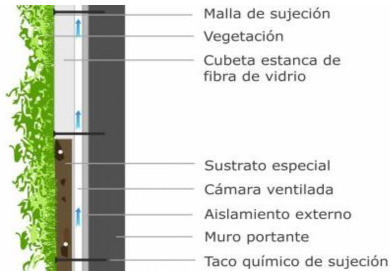
Figura 49: Corte de un Jardín Vertical con sus capas. Tomado de: Integral Garden.
