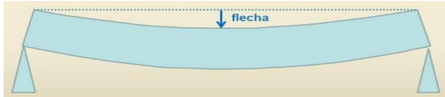
Figura 20. Deformación tipo flecha - Tomado de: La Web (ENCICLOPEDIA BROTO DE PATOLOGÍAS DE LA CONSTRUCCIÓN).
