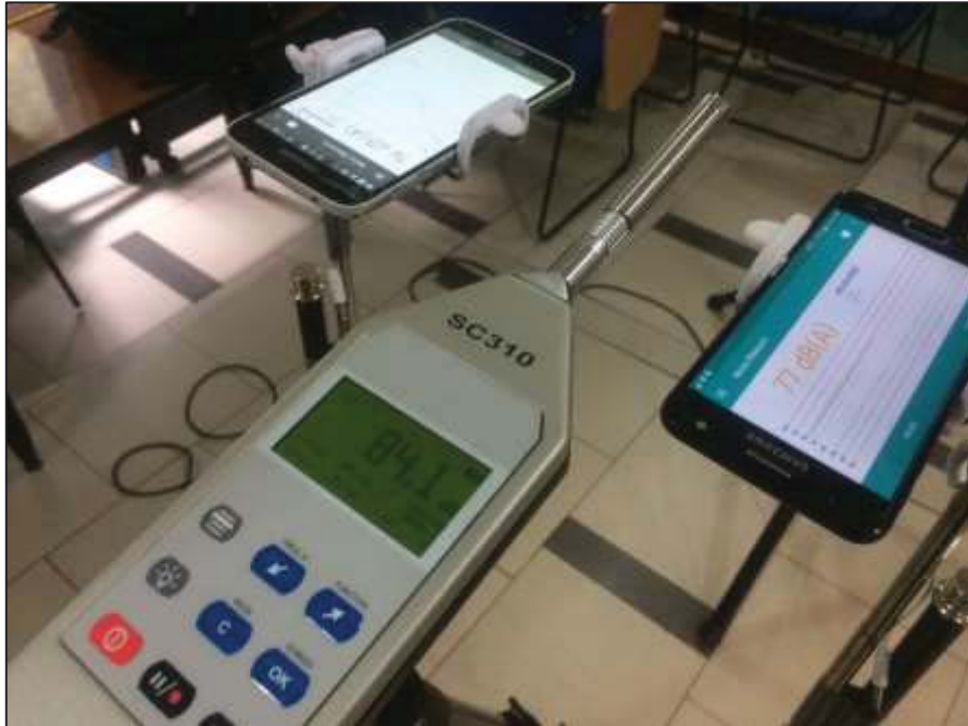
Figura 32. Sonómetro alineado con Samsung Galaxy S5 y Samsung Galaxy J5 Prime
