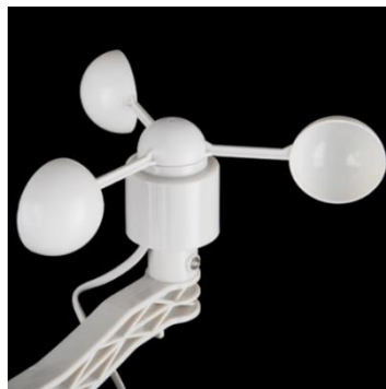
Figura 33. Anemómetro de copelas
