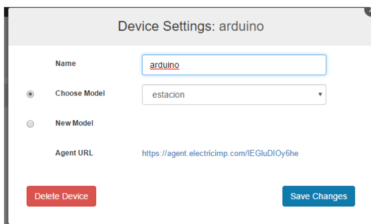
Figura 60. Configuración plataforma electric imp con redboard desde la web
