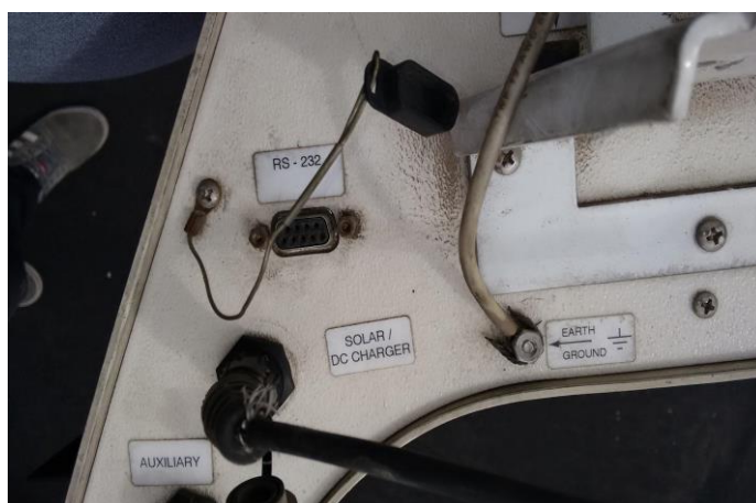
Figura 23. Puerto de comunicación RS-232 Estación UDLA
