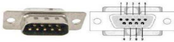
Figura 14. Conector DB9 hembra del sensor Nellcor.
