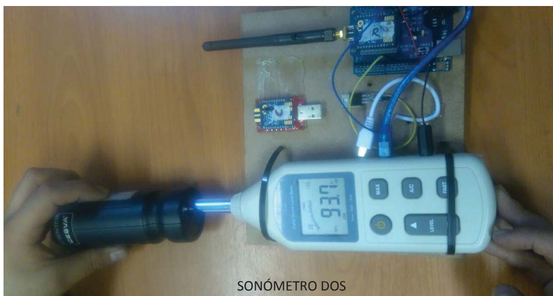
Figura 88. Calibración de los dos sonómetros SL1361.
