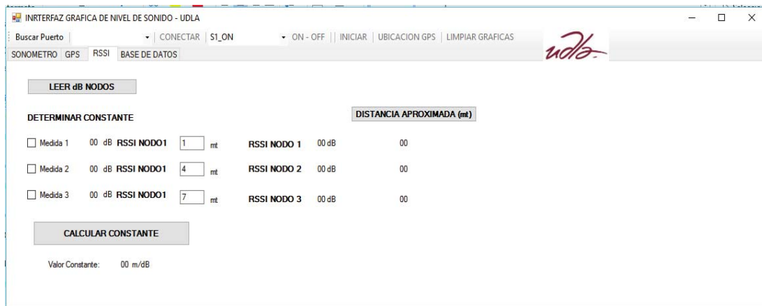
Figura 80. Interfaz para medir el nivel de RSSI.
