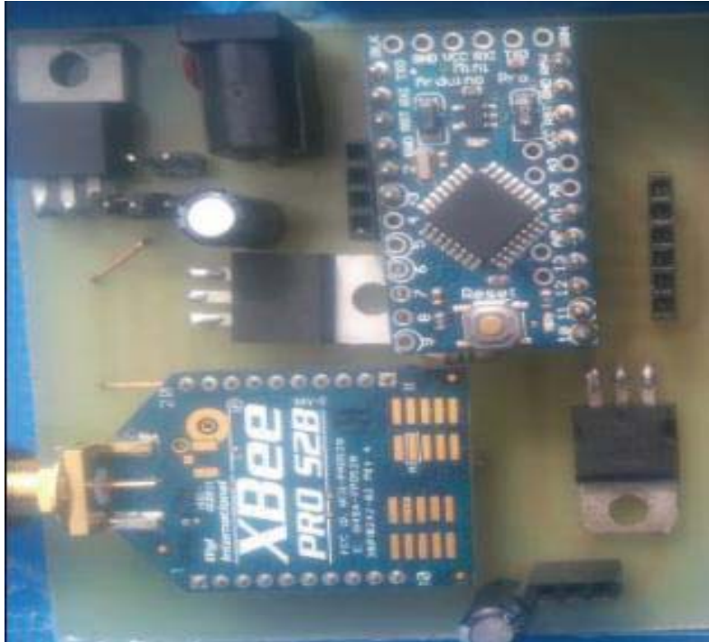
Figura 47. Placa del prototipo de medición de ruido.
