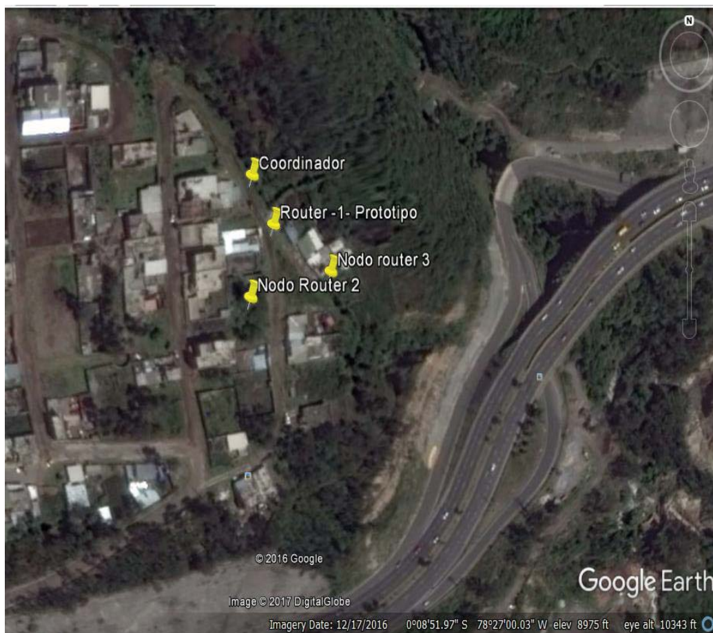
Figura 91. Distribución de nodos en el sitio de pruebas.
