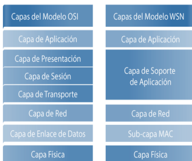
Figura 14. Comparación entre el modelo OSI y WSN.
