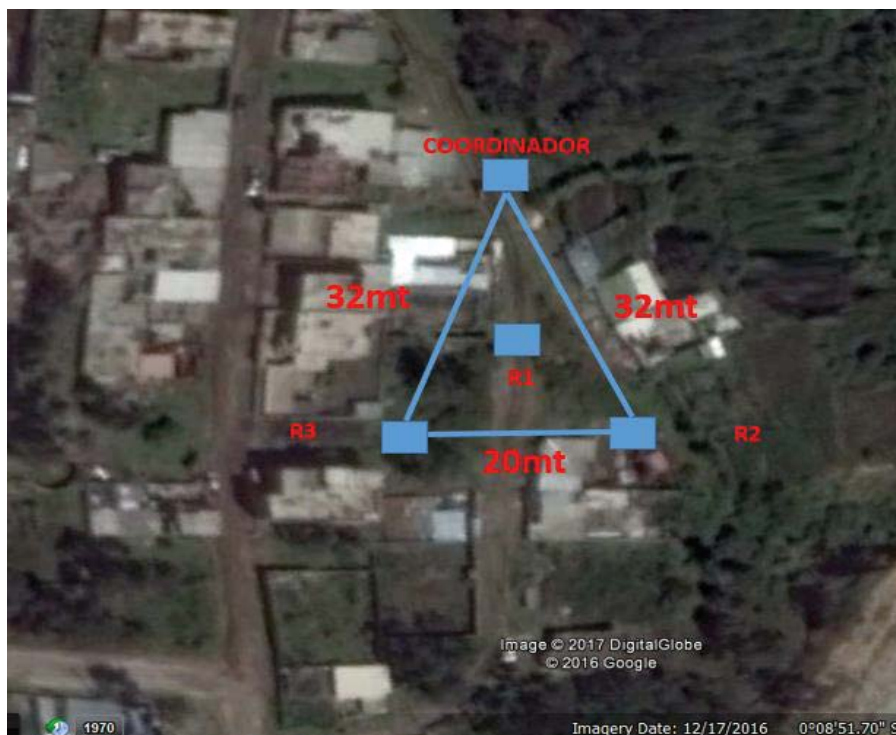
Figura 92. Distancias en metros entre los nodos. R1) router 1 R2) router 2 R3) router 3.
