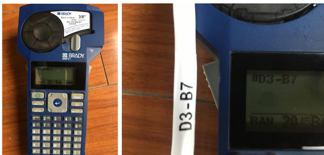
Figura 44. Etiquetado del cable
