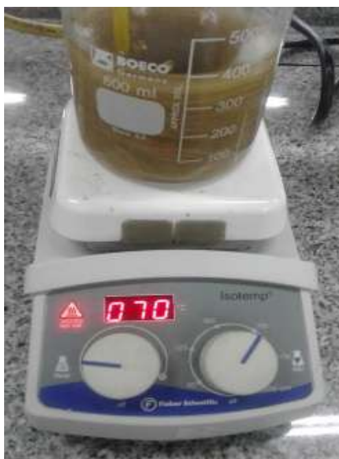
Figura 17. Agitación de 700 rpm en el lavado de quinua a 70°C.
