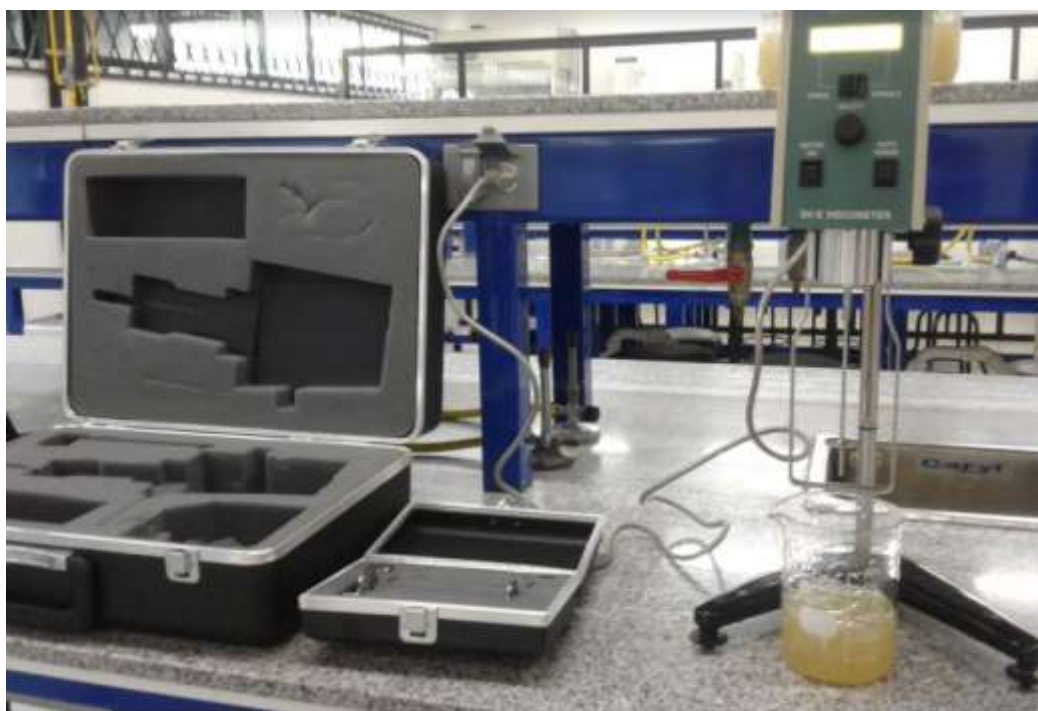
Figura 20. Medición de viscosidad en el viscosímetro Brookfield RVDVE
