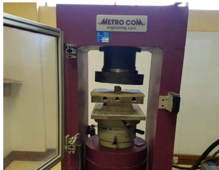
Figura 10. Equipo de compresión
