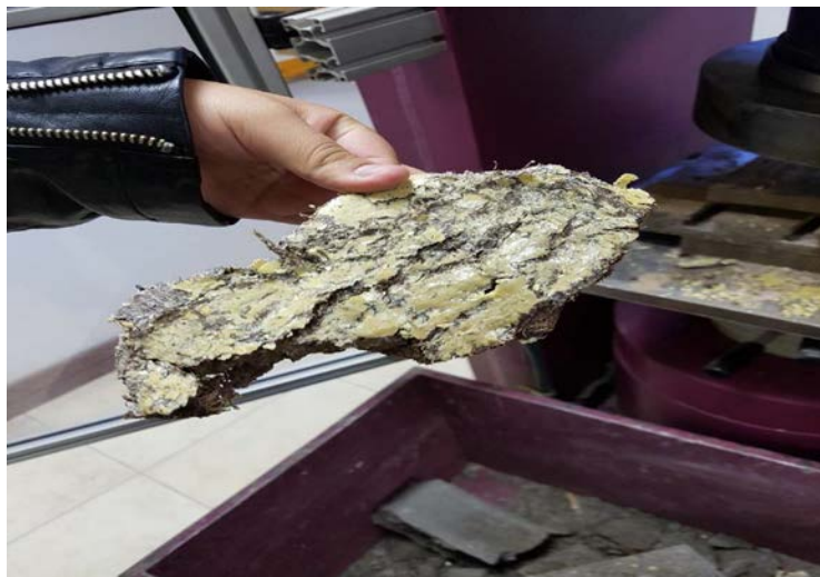
Figura 9. Muestra sometida a compresión a su máxima expresión
