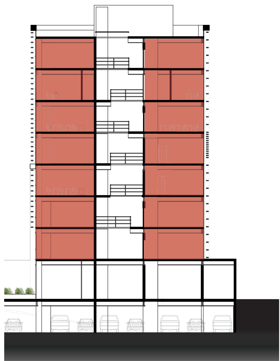
Calor producido por las actividades realizadas por los usuarios en los diferentes espacios.
