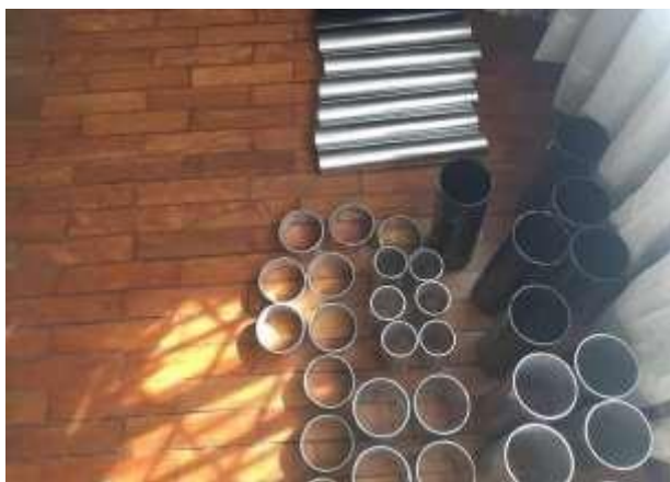
Figura 66. Tubos cortados y pintados
