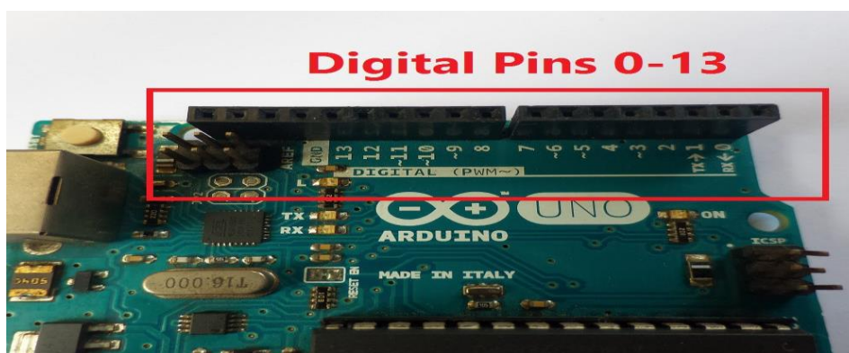
Figura 18. Arduino UNO entradas /salidas digitales
