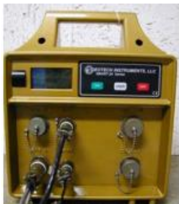
Figura 5. Digitalizador Geotech SMART-24.
