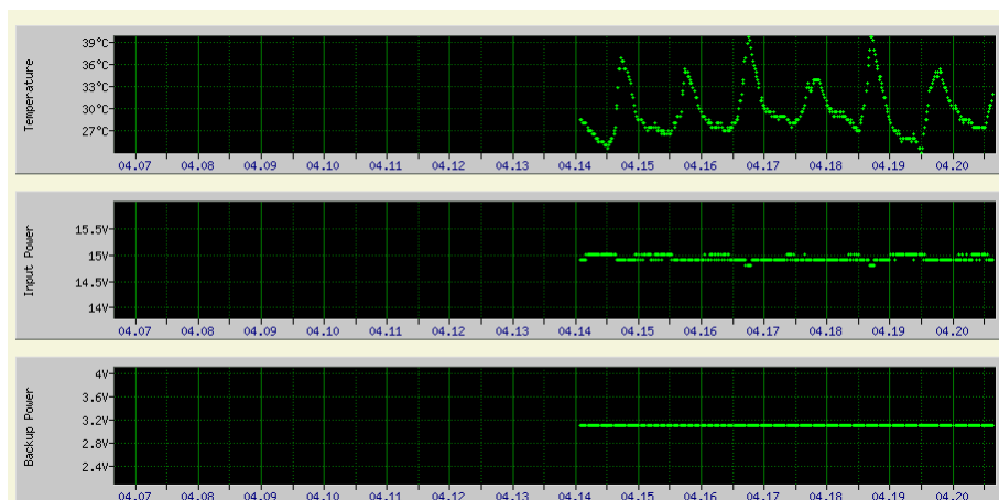
Figura 21. Parámetros de temperatura, potencia de entrada y de respaldo, estación sísmica banda ancha Mariscal Sucre.
