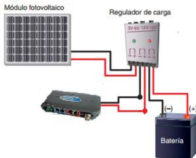
Figura 9. Sistema de Alimentación Fotovoltaico
