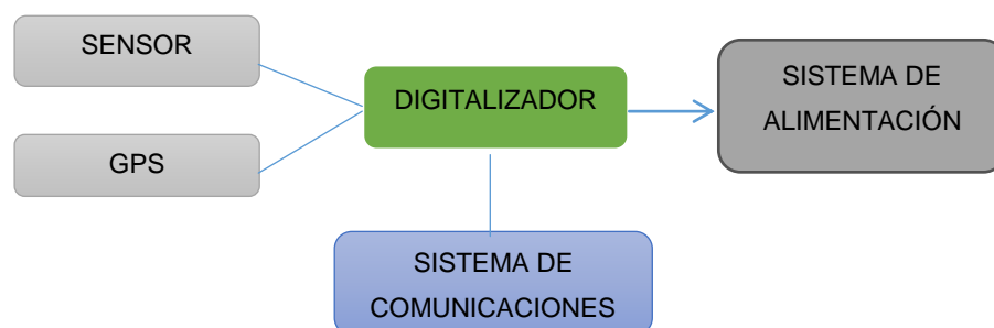
Figura 2. Diagrama Instrumentación Sísmica Banda Ancha.
