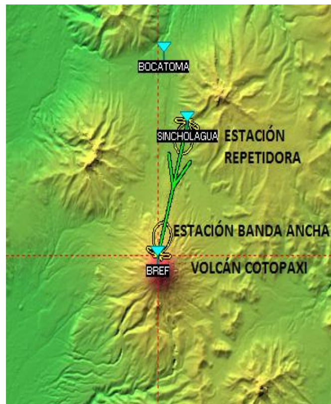
Figura 47. Enlace Sincholagua_BREF realizado en Radio Mobile
