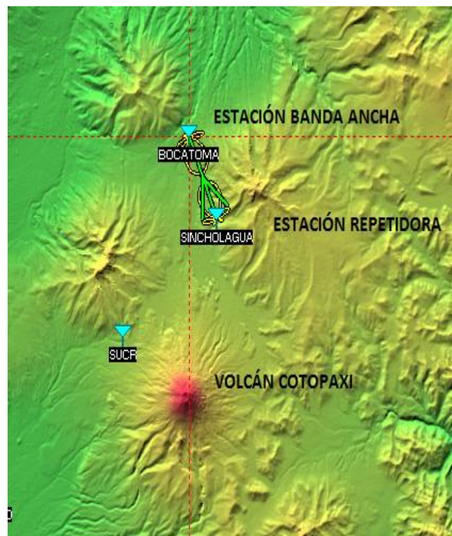
Figura 46. Enlace Sincholagua_Bocatoma realizado en Radio Mobile
