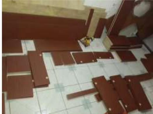
**Figura 29.** Plancha de aglomerado cortada
