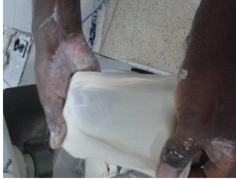
Figura 24. Prueba de verificación de elasticidad y extensibilidad.
