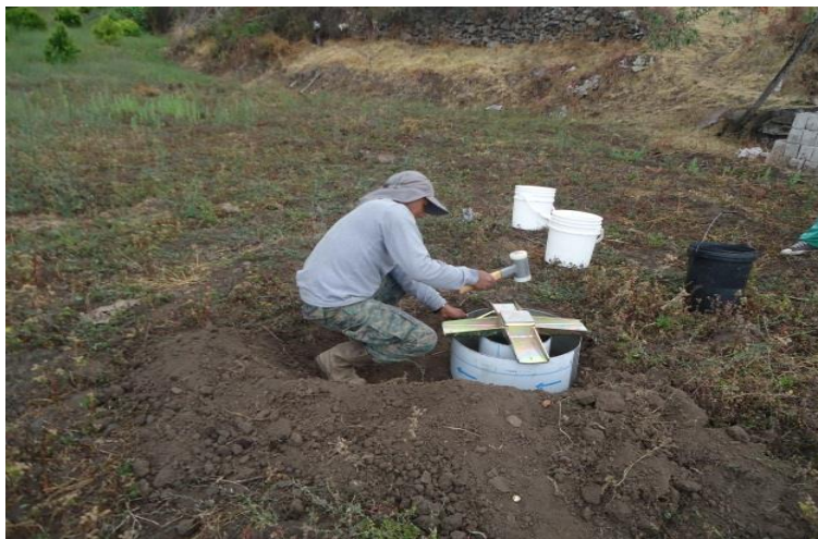
Figura 49. Toma de muestra de suelos
