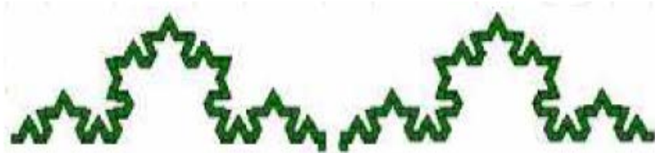
Figura 7. Antena fractal dipolo utilizando estándar de Koch Tomado de (Ahmed & Kaydar, 2011)
