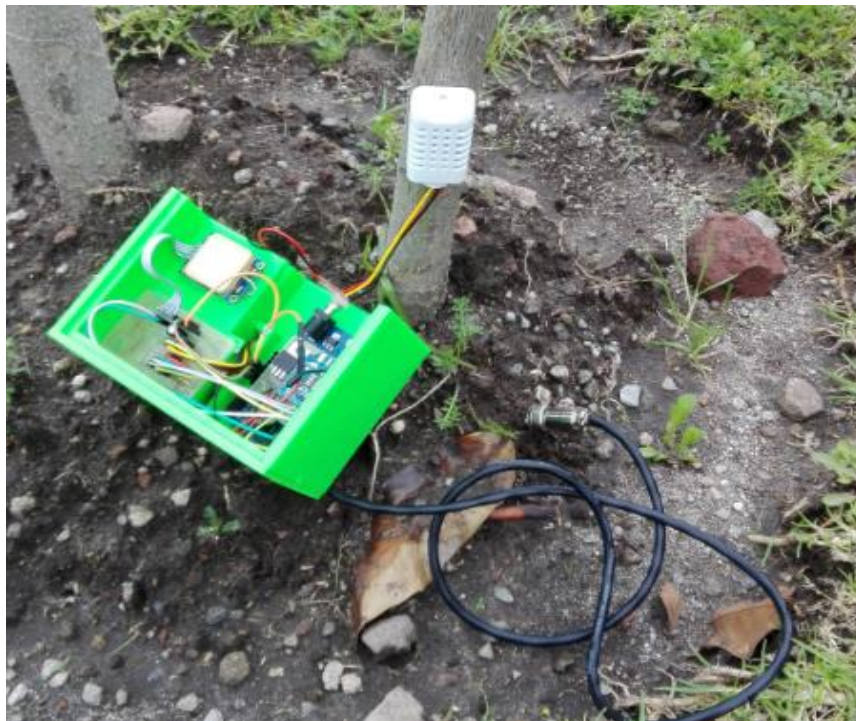
Figura 62. Nodo 1 recolectando medidas
