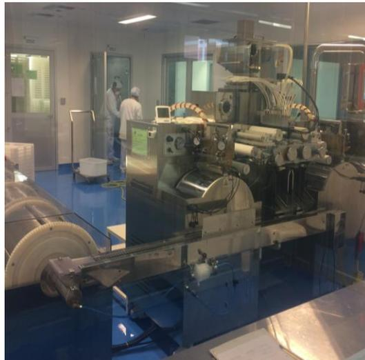
*Figura 21.* Área de fabricación de cápsulas blandas.
