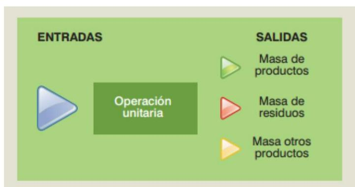
Figura 2. Método del balance de masas.
