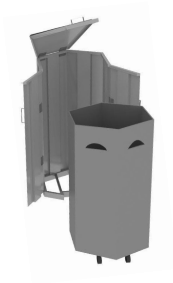
Figura 40. Contenedor externo abierto/contenedor interno expuesto
