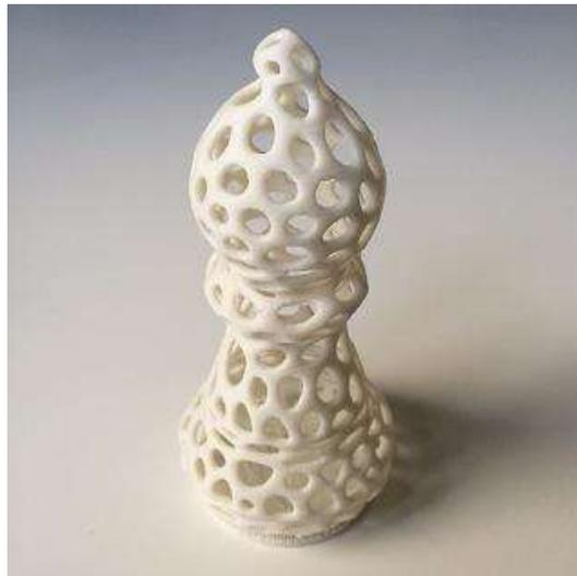
Figura41: Objeto decorativo impreso mediante el modelado por deposición fundida.
