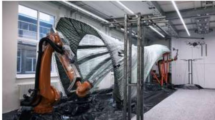
Figura 33: Proceso de fabricación pabellón ICD 2017
