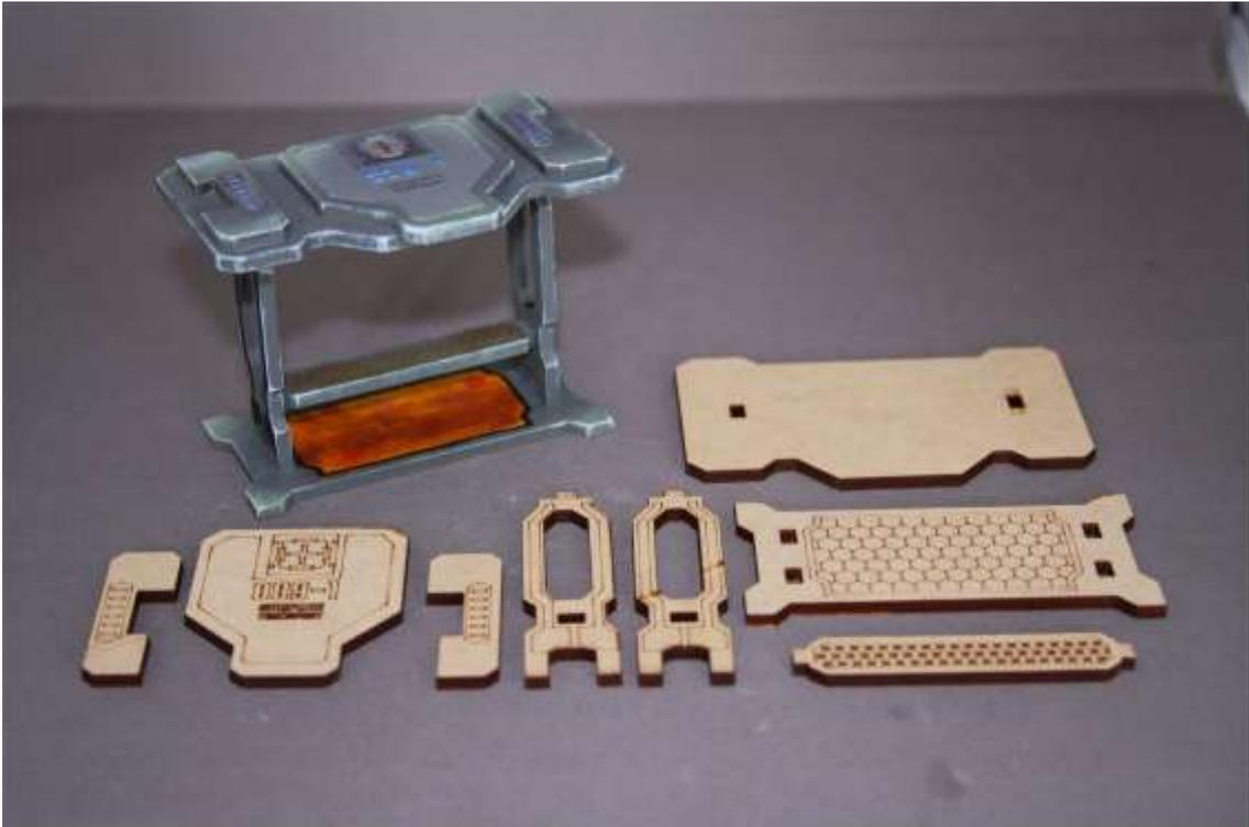
Figura 37: Cortadora laser Piezas cortadas y grabadas a laser. Acabado final escritorio a escala.
