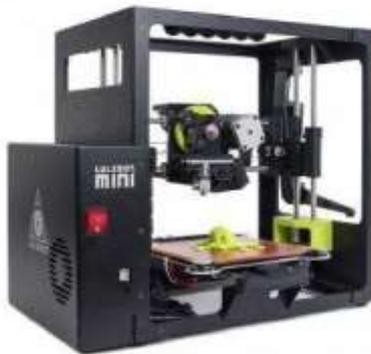
Figura 38: Impresora 3D común de extrucción de material.
