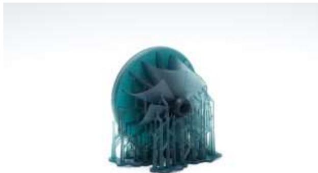
Figura 42: Soportes y ventilador impresos mediante estereolitografía
