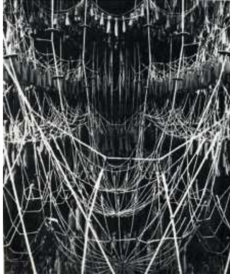
Figura 14: Experimento de cuerdas tensadas para el templo de la sagrada familia de Catalunya.
