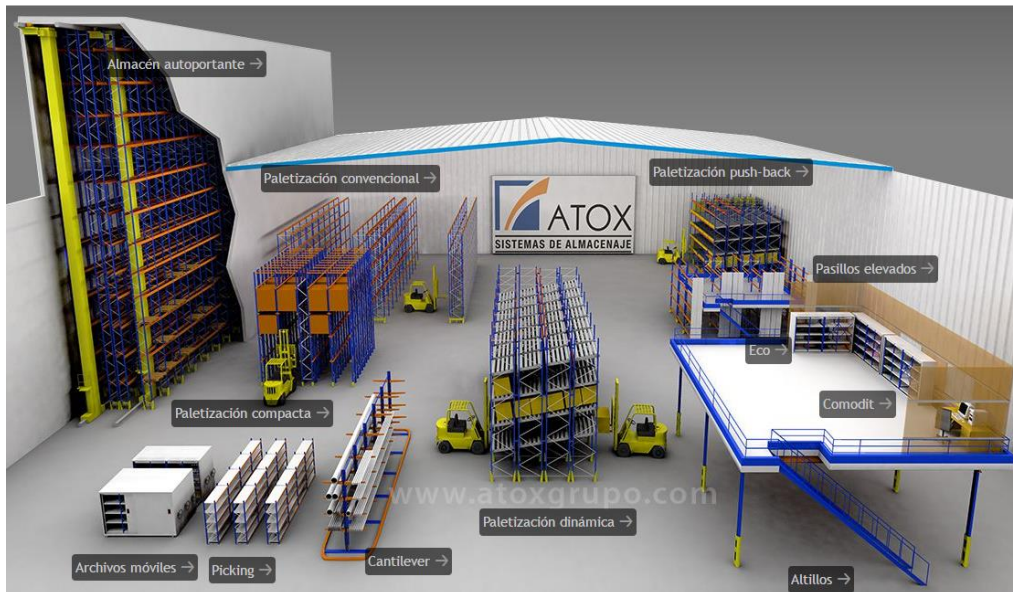
Figura 21. Ejemplos de sistemas de almacenamiento Tomado de: (ATOX: Sistemas de Almacenaje, 2017)
