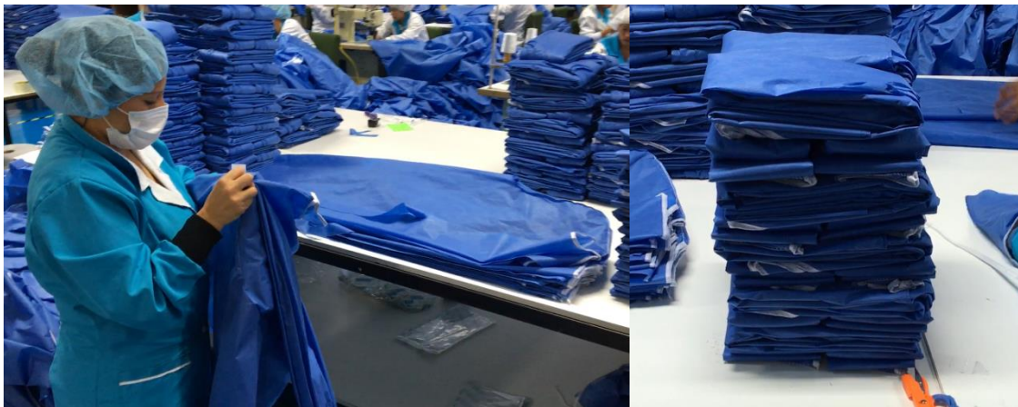
Figura 25. Rematadora en proceso de estirado y apilado de batas.
