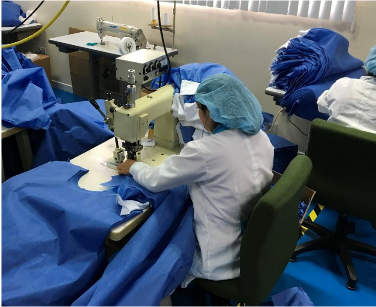
Figura 19. Costurera en proceso de unión de cuerpo y mangas.
