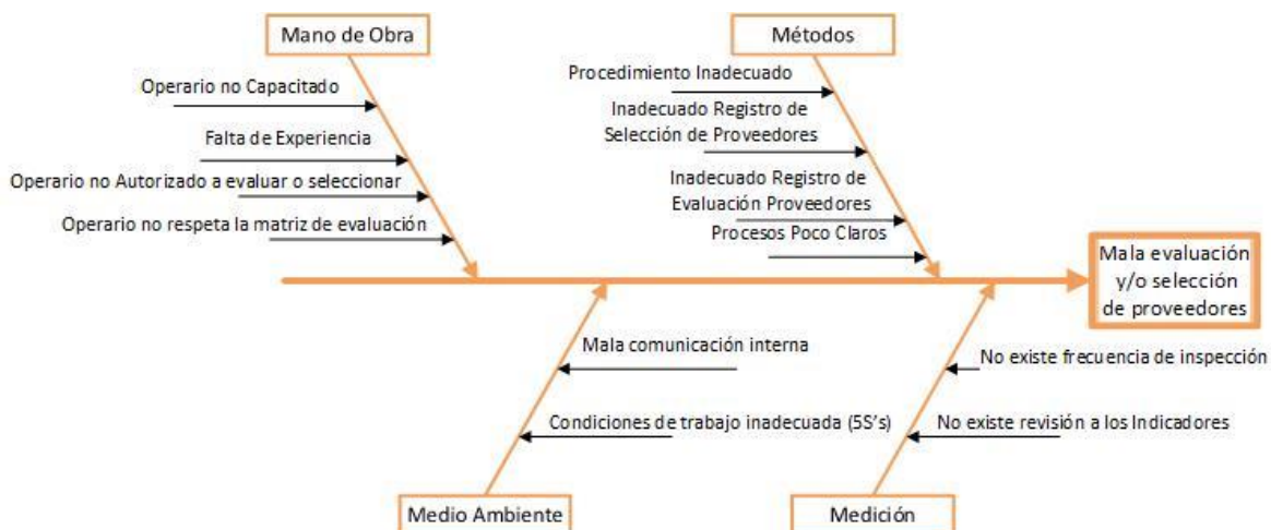
Figura 36. Diagrama causa efecto de la falla encontrada en cotizar con proveedores
