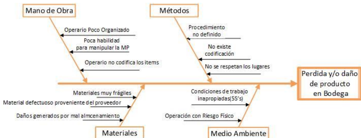
Figura 35. Diagrama causa efecto de la falla encontrada en almacenar
