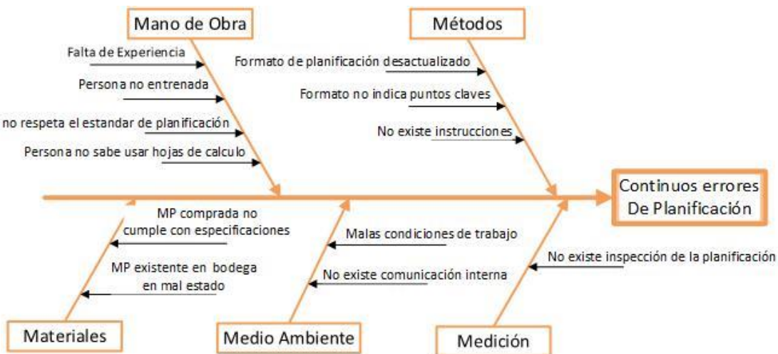
Figura 37. Diagrama causa efecto de la falla encontrada en planificar las tareas
