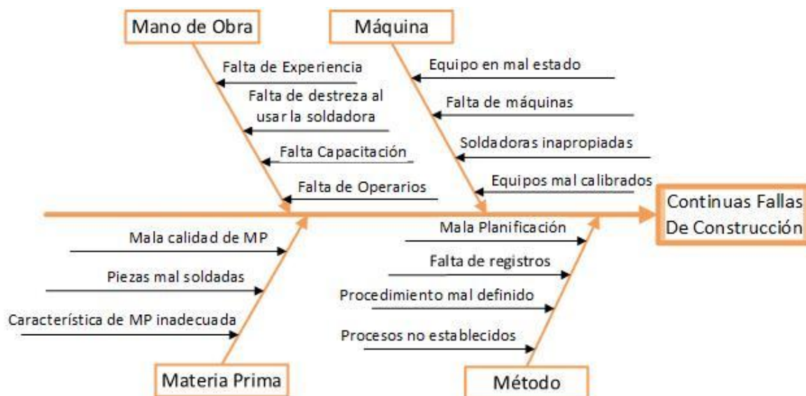
Figura 39. Diagrama causa efecto de la falla encontrada en construir piezas
