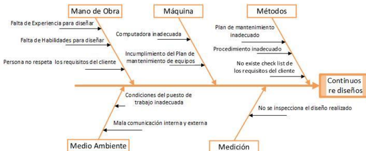
Figura 38. Diagrama causa efecto de la falla encontrada en realizar cambios
