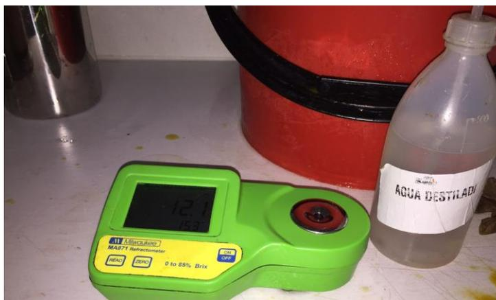
Figura 16. Medidor grados Brix y Agua destilada para calibración
