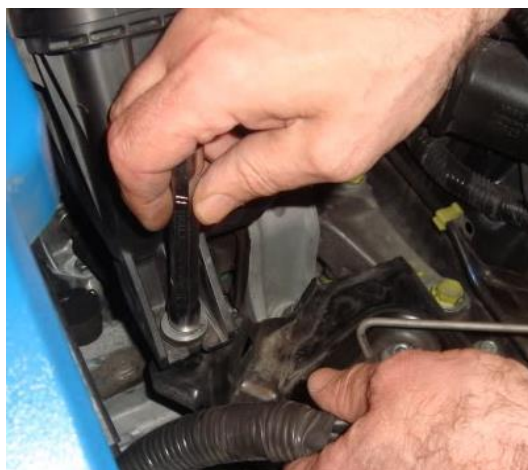
Figura 30. Purga y cambio de filtro superior de combustible
