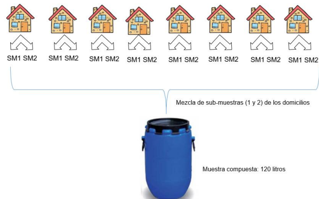
Figura 11. Esquema de muestreo de sub-muestras 1 y 2 (SM1 y SM2) y obtención de la muestra compuesta.
