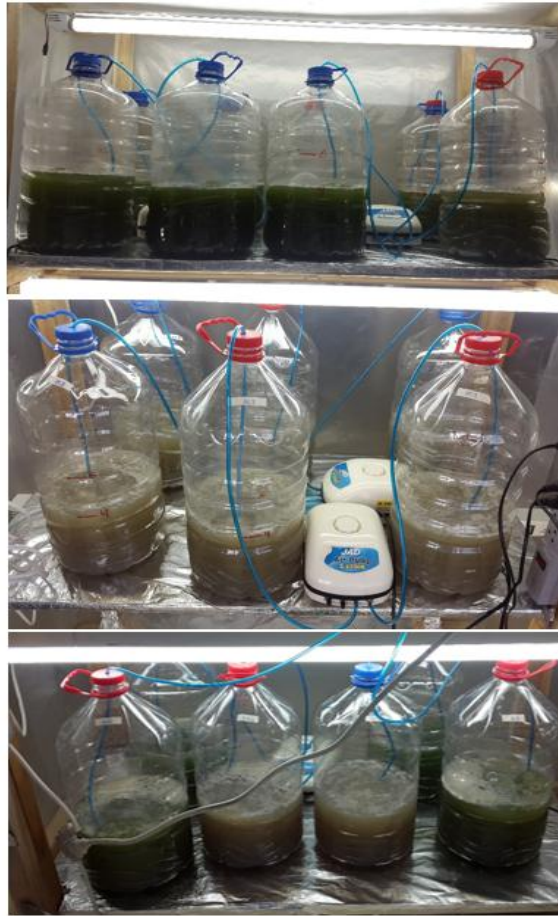
Figura 13. Equipamiento de las 20 unidades experimentales, aireación individual e iluminación superior mediante lámparas fluorescentes.
