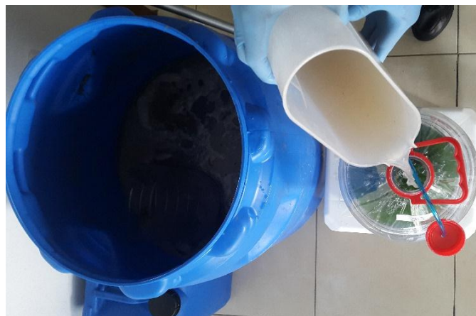
Figura 14. Aforo de las unidades experimentales a volumen de 4 L con agua residual gris (muestra compuesta).
