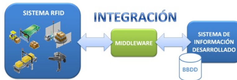
Figura 6. Diagrama de bloques de la interacción del middleware con el sistema RFID y el sistema de gestión.
