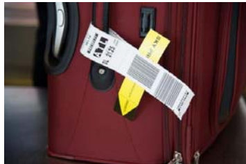
Figura 9. Etiquetas RFID ubicadas en el equipaje para poder ser identificadas Tomado de DELTA, s.f.
