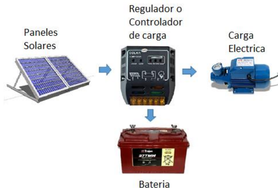
Figura 7. Instalación de un sistema de energía solar fotovoltaica
