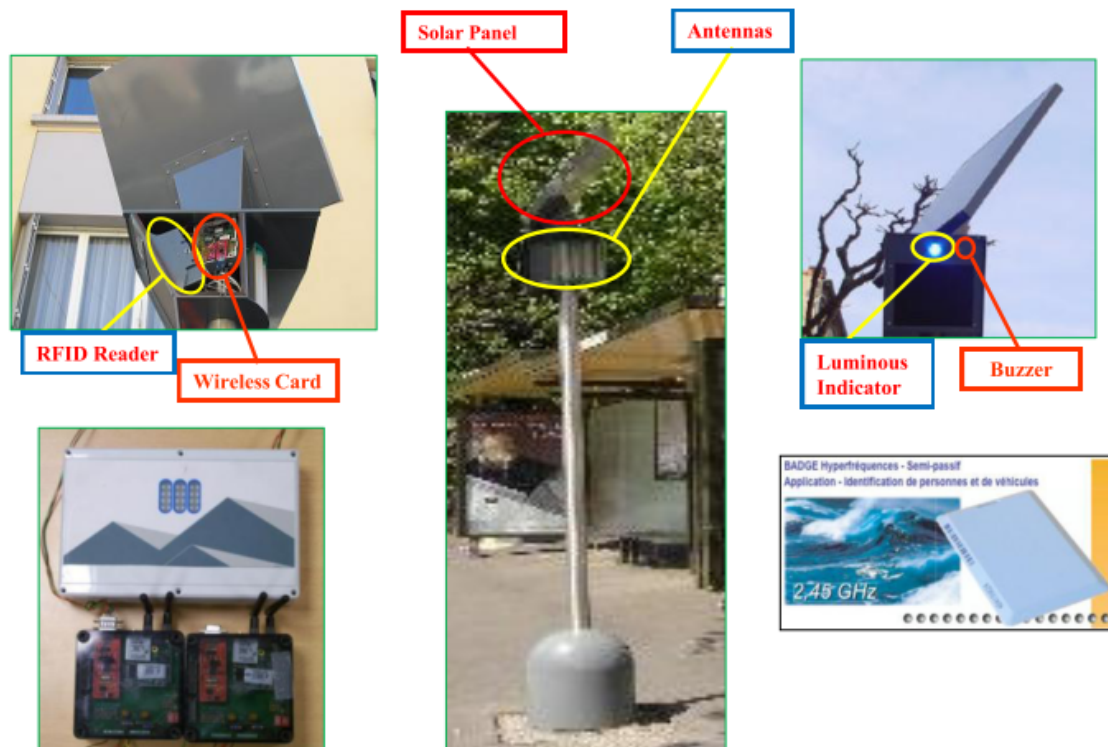
Figura 9: Elementos del subsistema de estación de autobús Adaptada de: (Zhou, Hou, Zuo, & Li, 2012, pág. 10689)
