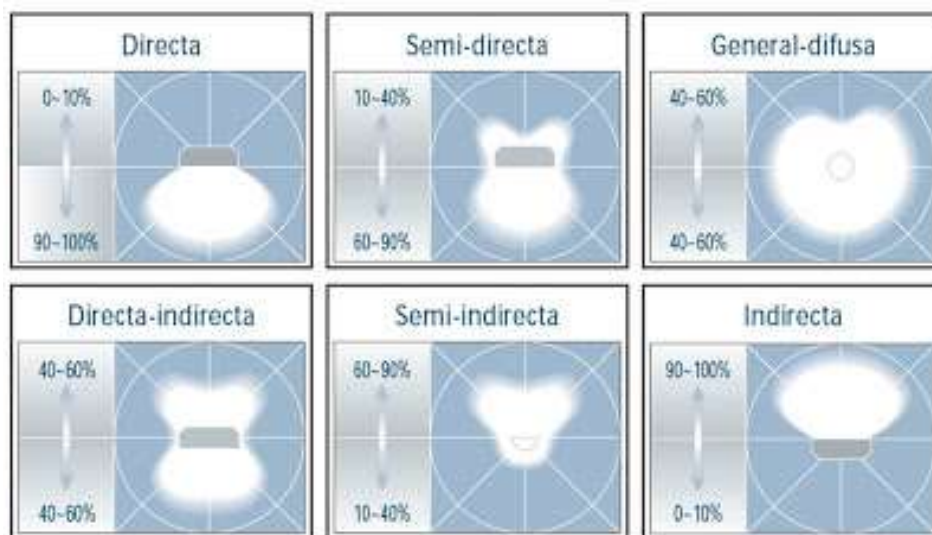
Figura 19. Tipos de iluminación para los ambientes interiores.
