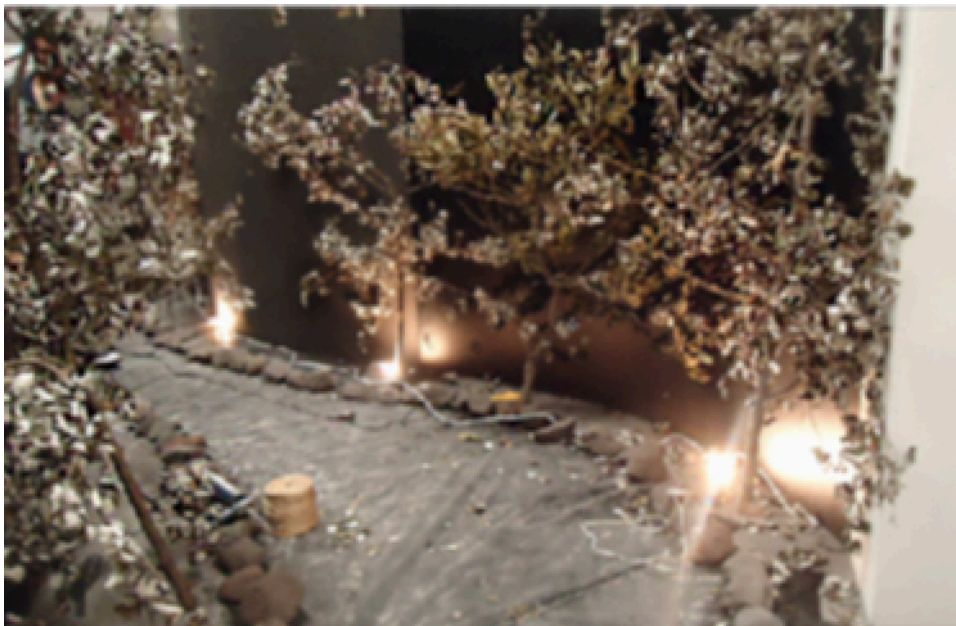
Figura 25. Fotografía de las luces instaladas y conectadas para, medir la intensidad luminosa. Primera prueba de iluminación.
