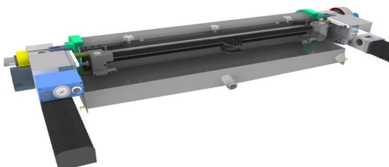
*Figura 82.* Sistema de cambio rápido de rasqueta.
