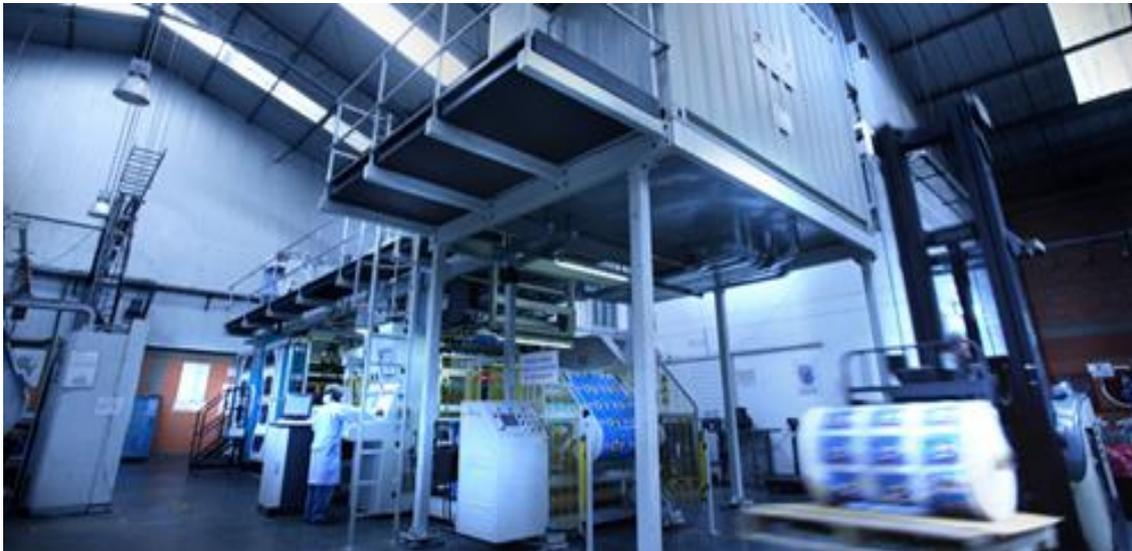
*Figura 9.* Impresora flexográfica.
