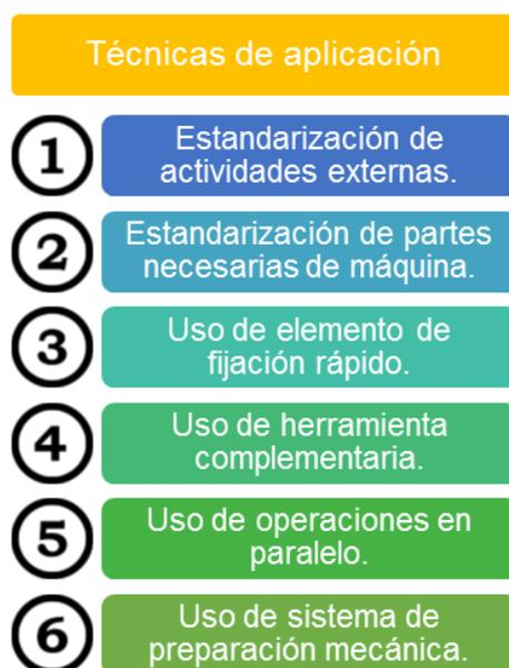
Figura 32. Técnicas de aplicación de SMED.
