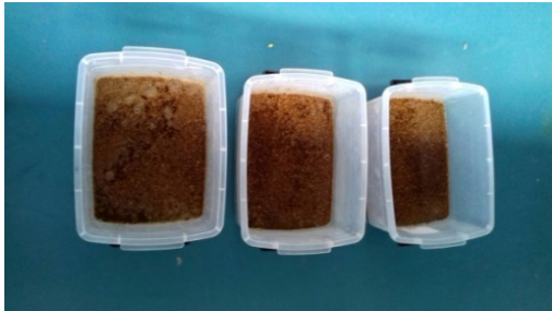
Figura 23. Tratamiento 2( esterilizado), deslignificación de la cáscara de piña y naranja.
