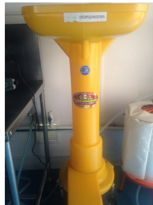
Figura 16. Triturado de la materia prima (piña y naranja) usando el molino Pome Fruit Grinde.
