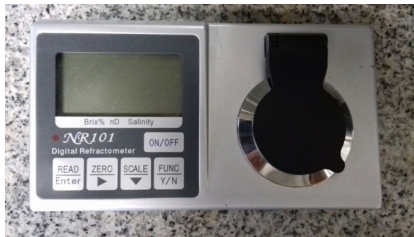
Figura 26. Equipo para la medición de los grados Brix del mosto y del jugo piña y naranja.
