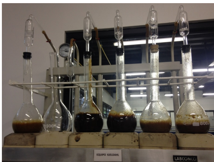
Figura 29. Destilación simple de todas las muestras de los tratamientos 1 y 2 de las materias primas de piña y naranja.
