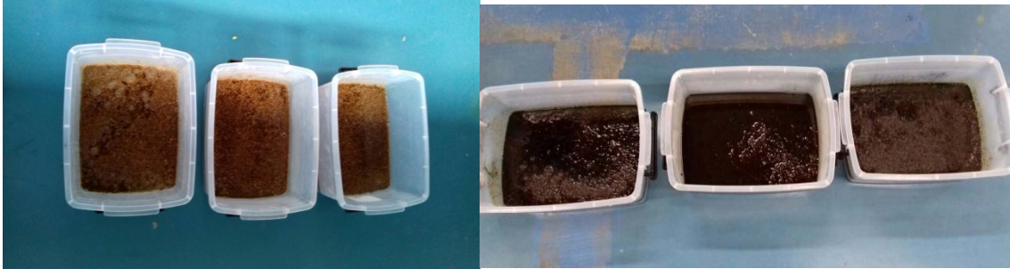
Figura 21. Tratamiento 1(no esterilizado), deslignificación de la cáscara de piña y naranja.
