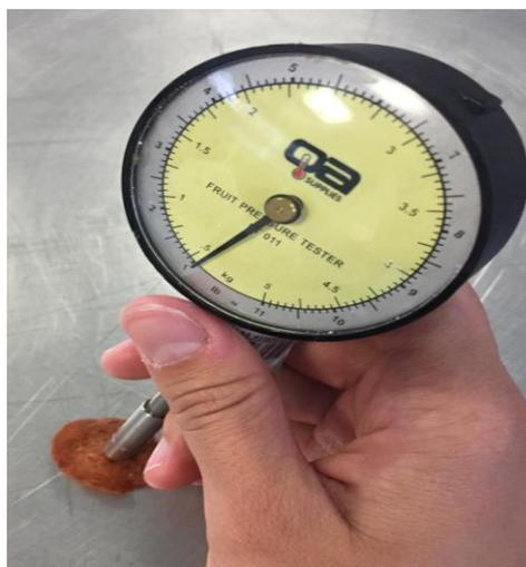
*Figura 10.* Medición textura de chip cárnico de almidón de yuca horno.
