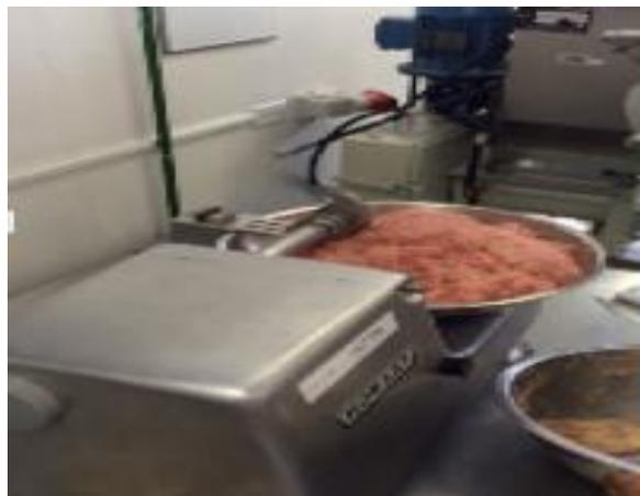
*Figura 3.* Mezclado y emulsificado de producto en proceso en el cutter.
