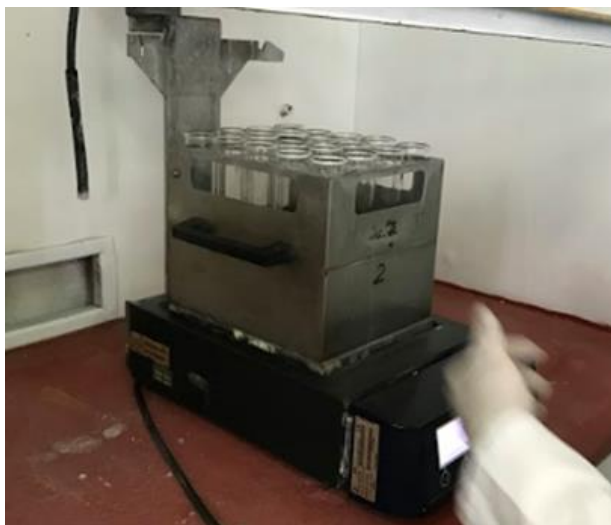
Figura 10. Muestras de chíá en el digestor para el análisis de proteína Kjeldahl.
