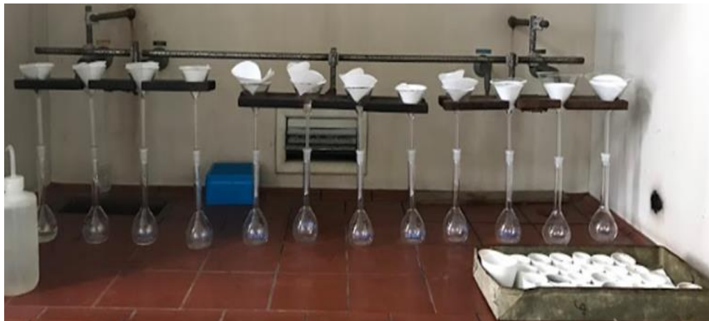
Figura 16. Filtrado de muestras para análisis de macro y micro minerales.
