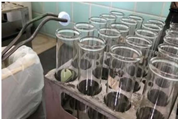
Figura 8. Adición de pastillas Kjeldahl para el análisis de proteína de las muestras de chíá.
