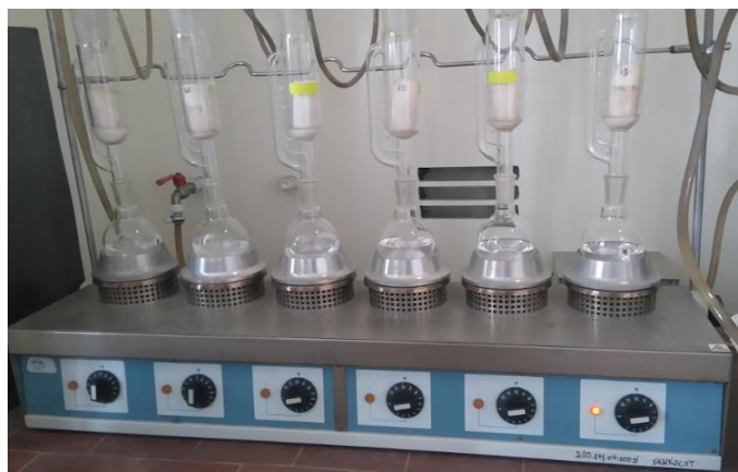
Figura 6. Extracción de grasa de la semilla de chía en equipo Soxleth.
