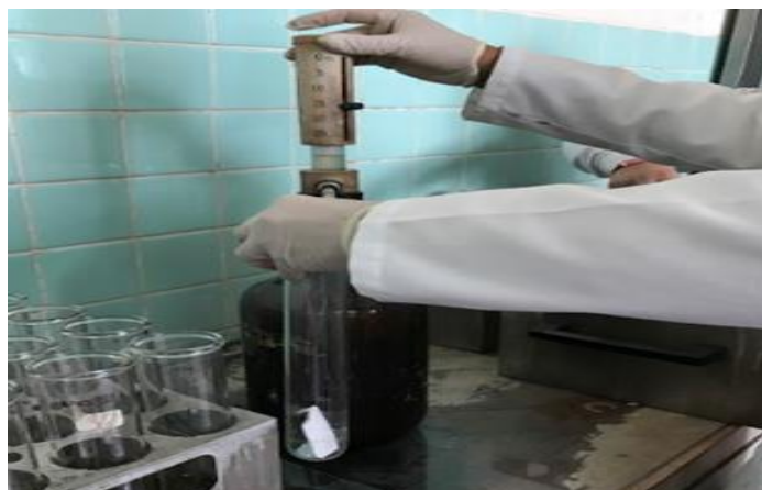
Figura 9. Adición de H_2SO_4 para el análisis de proteína de las muestras de chíá.
