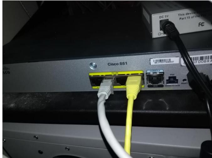
*Figura 12.* Conexión del Router Cisco 881 al equipo Convertidor FO a RJ45
