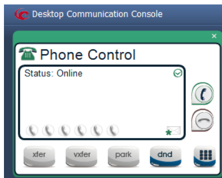
Figura 82. DCC en estado Online, registro OK con IP-PBX
