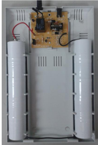
Figura 22. Bancos de baterías de 12V, 600 mAh de la marca Alcatel
