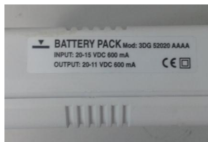
Figura 23. Especificaciones del banco de baterías
