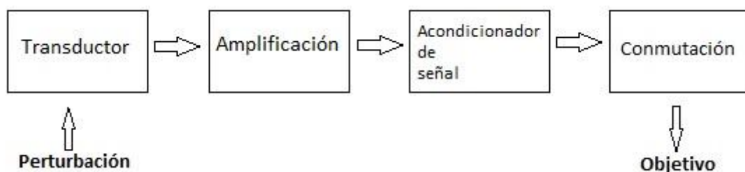
Figura 27. Estructura general del sensor de impactos.
