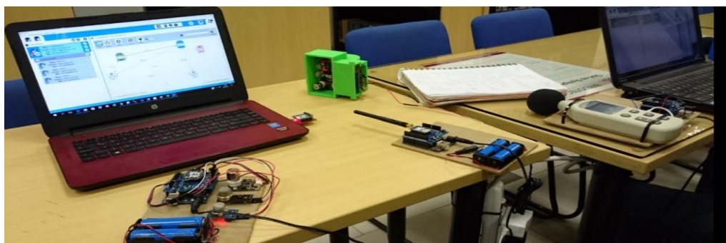
Figura 79. Montaje de red WSN
