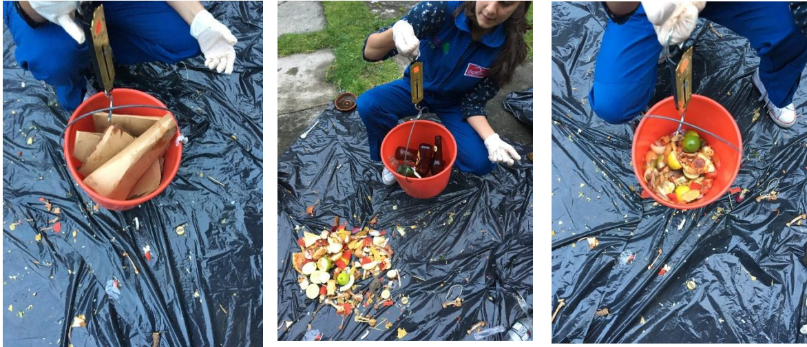
Anexo 3.6 Peso de las fracciones de residuos sólidos utilizando una balanza casera (Fierro, 2017).
