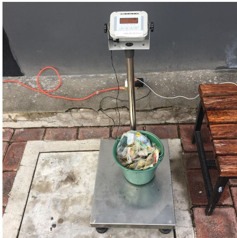
Anexo 3.7 Peso de las fracciones de residuos sólidos utilizando una balanza electrónica (Fierro, 2017).
