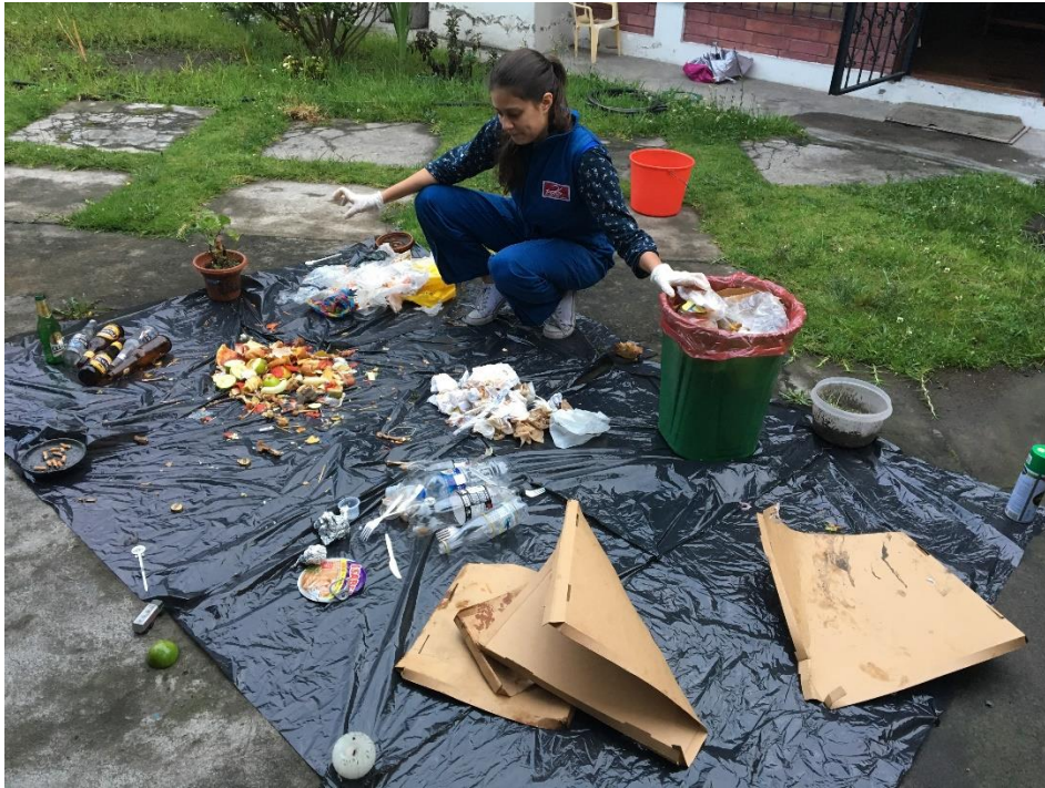
Anexo 3.4 Separación de fracciones de residuos para determinar el porcentaje de las mismas y composición total de la muestra analizada (Fierro, 2017).
