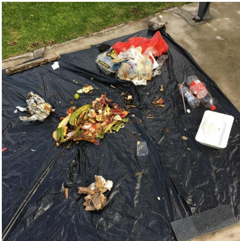
Anexo 3.5 Fracciones de residuos establecidas, separadas correctamente para ser pesadas y analizadas (Fierro, 2017).
