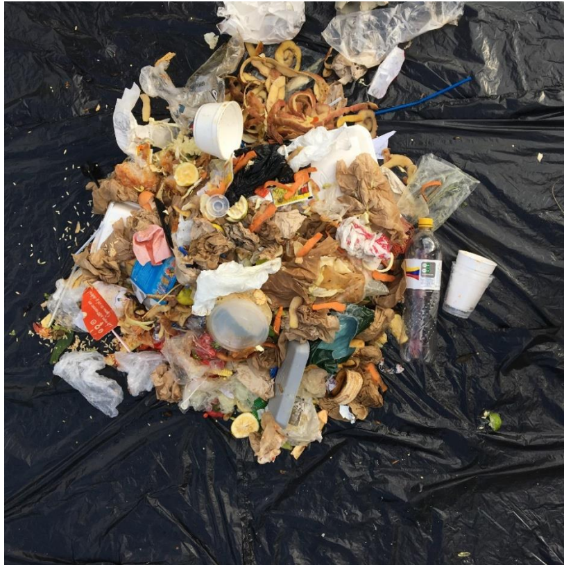
Anexo 3.2 Formación del círculo de residuos para desarrollar el proceso de cuarteo (Fierro, 2017).
