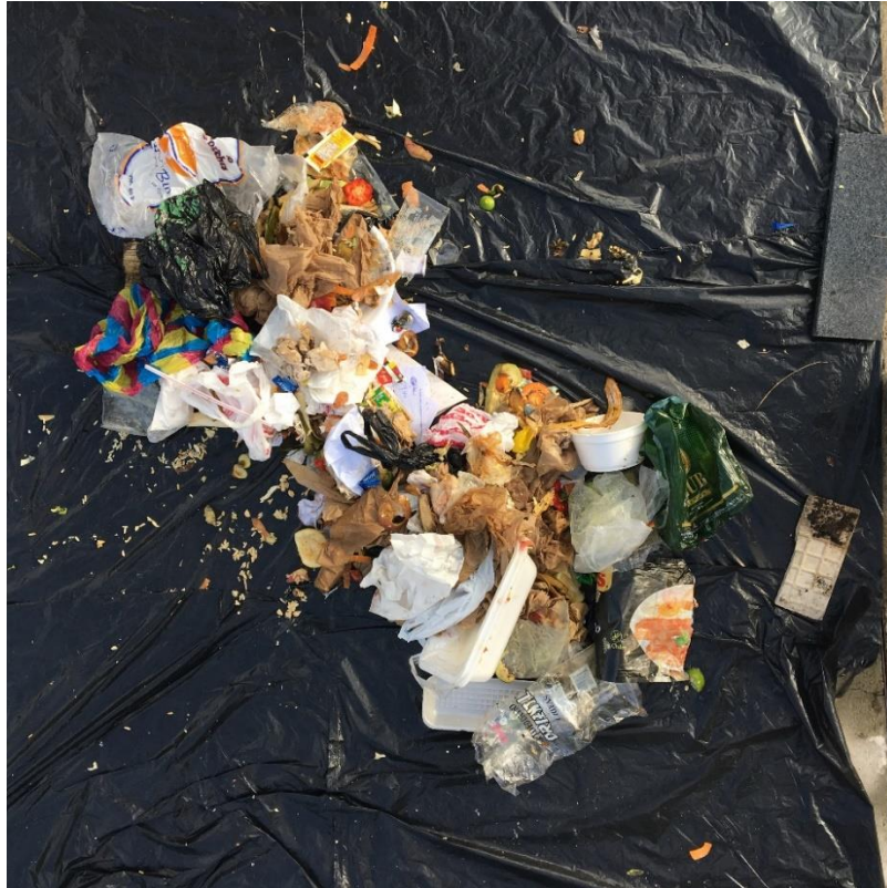
Anexo 3.3 Selección de 2 partes del círculo elaborado para el método de cuarteo (Fierro, 2017).
