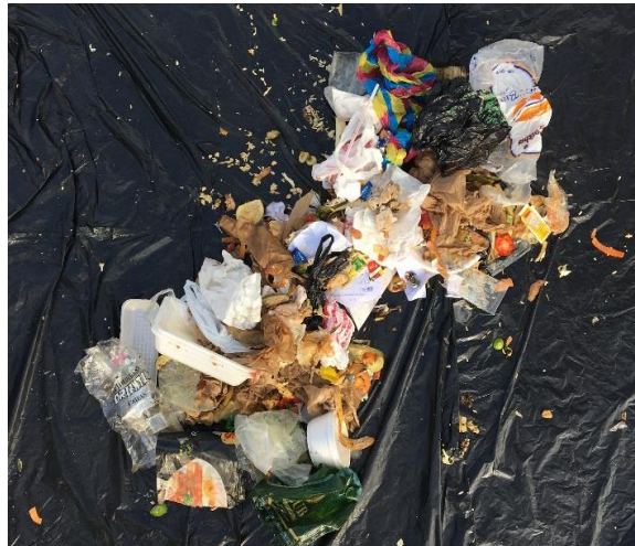
Figura 10. Selección de las dos secciones opuestas establecidas por el método de cuarteo del CEPIS.
