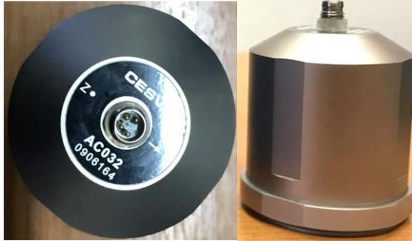
Figura 8. Acelerómetro CESVA AC032
