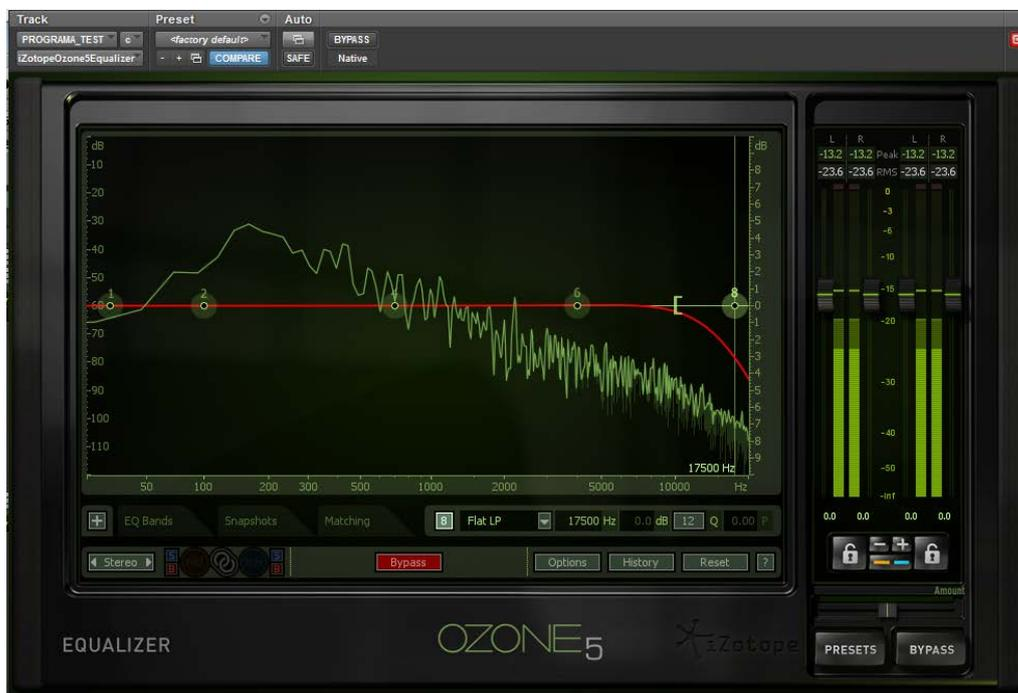
Figura 78. Captura del ecualizador *OZONE* con el filtro pasa bajo usado.
