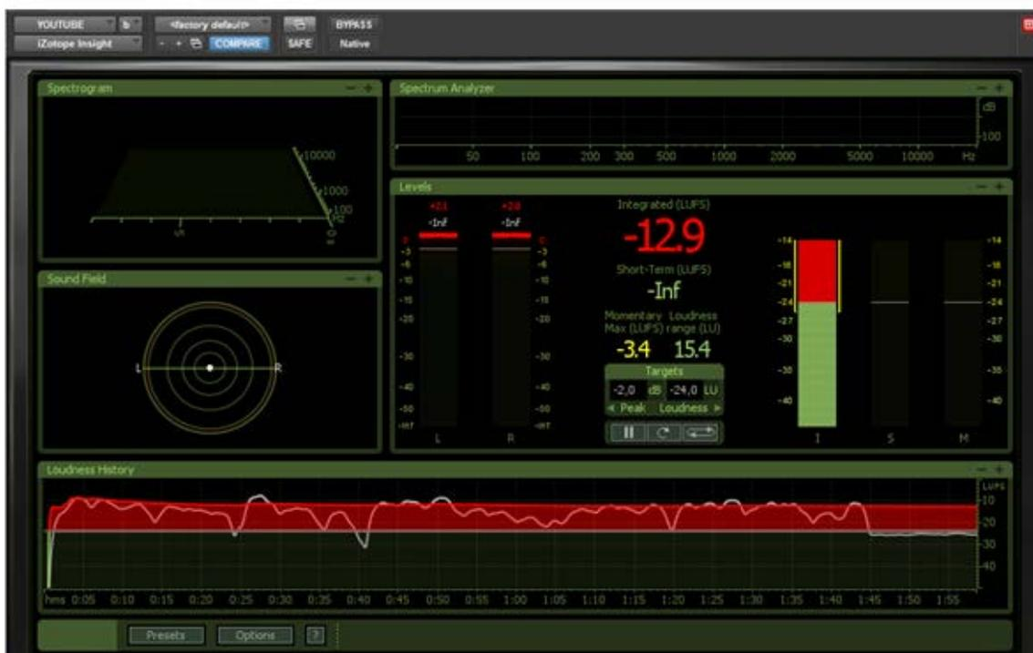
Figura 18. Medidor de sonoridad tipo *plugin* iZotope INSIGHT.
