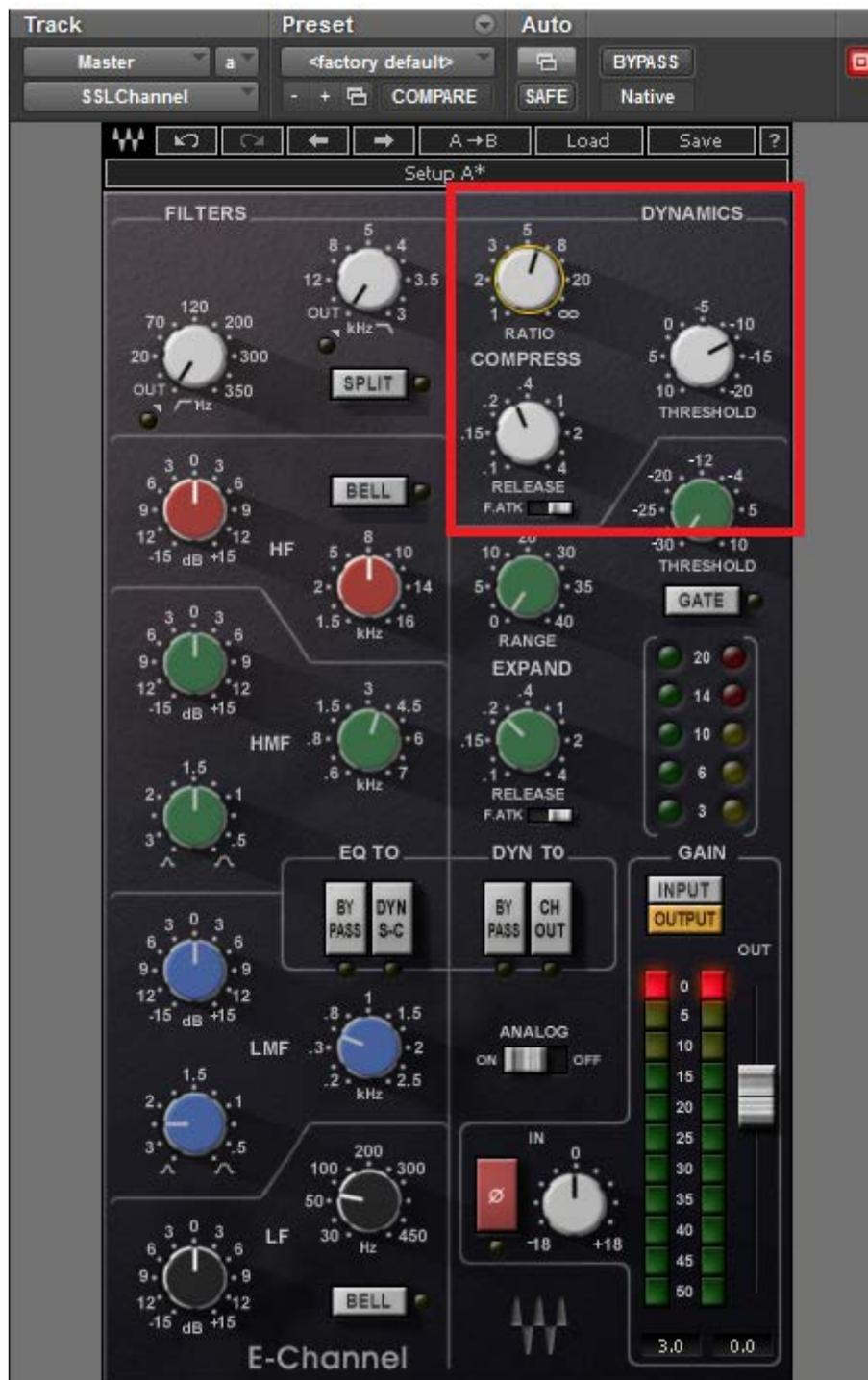
Figura 3. Captura del SSL Channel tipo plugin, la etapa de compresión se encuentra encerrada en el recuadrado rojo.
